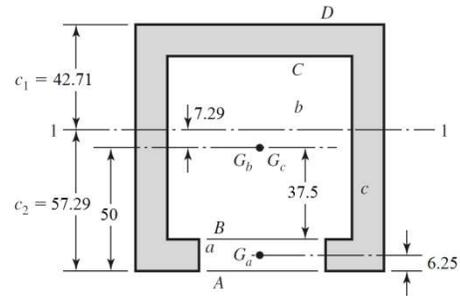
$$A_a = 625\ \text{mm}^2, A_b = 5625\ \text{mm}^2, A_c = 10\ 000\ \text{mm}^2$$
